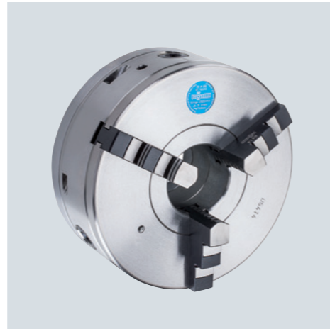
Noch mehr Genauigkeit gibt es bei unseren Planspiralfutter in der Hi-Tru Ausführung. Mit einer Einstellgenauigkeit von bis zu 0,005 mm lässt sich jede Backe über eine eigene Spindel separat verstellen.
