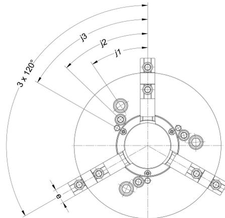
C 15 3-Backen Kraftspannfutter DURO-A RC, mit Backen-Schnellwechselsystem, mit Einzelentriegelung, geradzahnt, Kurzkegelaufnahme DIN ISO 702-1
